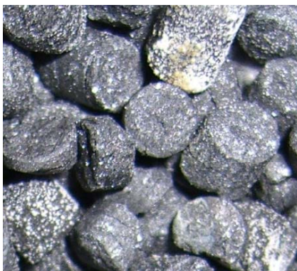
Beladung einer dopetac sulfo 100 mit 95Gew.% Schwefel
