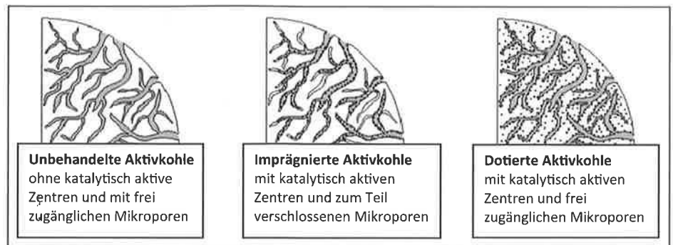
Abbildung 1: Porenstruktur un behandelter und modifizierter Aktivkohlen
