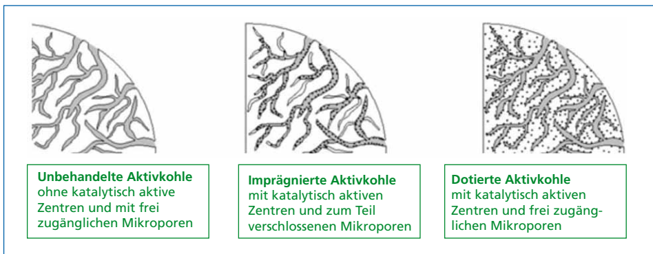
Bild 1: Porenstruktur unbehandelter und modifizierter Aktivkohlen
